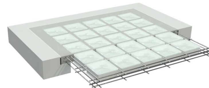
Draufsicht auf die horizontale SGB-Platte (extrados)
